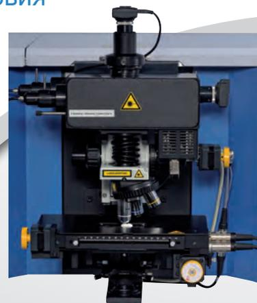
Конфигурация с открытым микроскопом с DuoScan.
